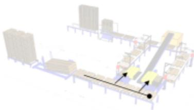
Eine der Gesundheits-Technischen Verbesserungen der Arbeitsverfahren bei der Reparatur von Paletten ist die Verwendung von einem Entstapler. War früher ein [Entstapler](#) für jeden [PalletSaw](#) notwendig, haben wir jetzt ein System, wo ein Entstapler gleichzeitig mehrere PalletSaws mit beschädigten Paletten versorgt. Sind Sie neugierig ob dieses in Ihrem Unternehmen passen würde? Rufen Sie an oder senden Sie uns eine Mail.
